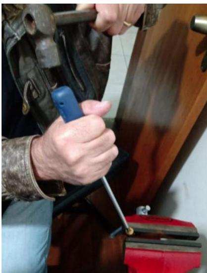
A extremidade de um instrumento pontiagudo (como uma chave de parafusos tipo “Philips”) é posicionada no centro da espoleta e a outra extremidade é firmemente golpeada com um instrumento contundente (por exemplo, um martelo). Dessa forma, caso a espoleta seja detonada, o teste de sua eficiência é positivo.
