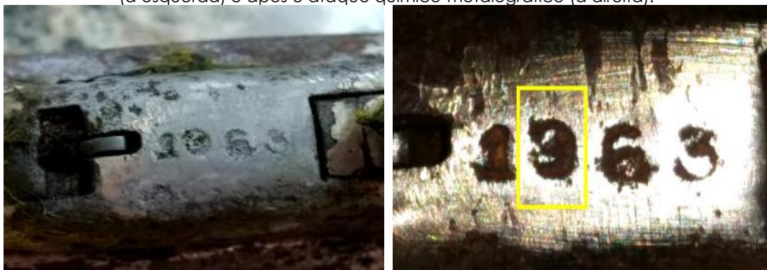
Figura 4 – Imagem do número de série de um revólver antes do ataque químico-metalográfico (à esquerda) e após o ataque químico-metalográfico (à direita).
