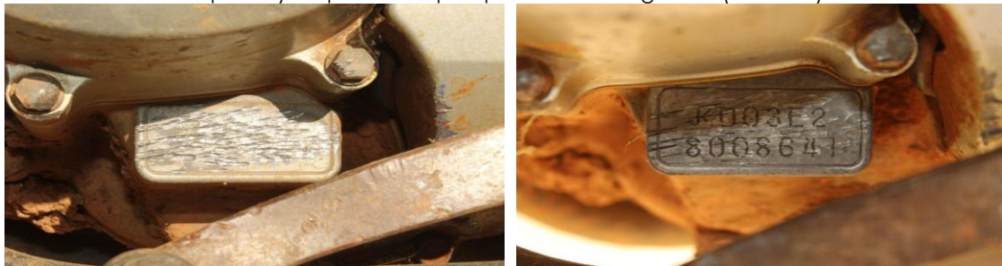
Figura 3 – Imagem da numeração do motor antes do ataque químico-metalográfico (à esquerda) e após o ataque químico-metalográfico (à direita).
