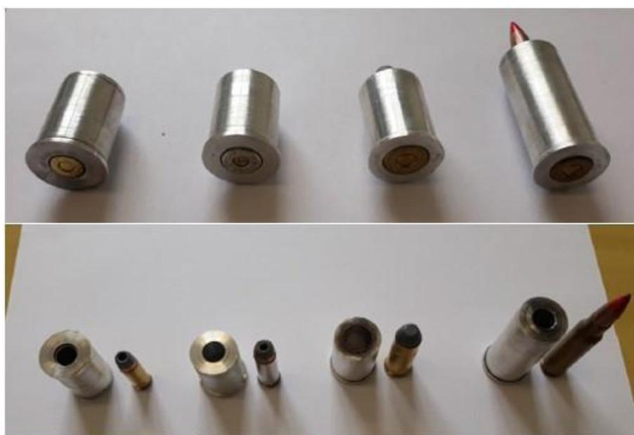
Figura 08 – Munição acoplada a adaptador de material sintético para arma de calibre 12
