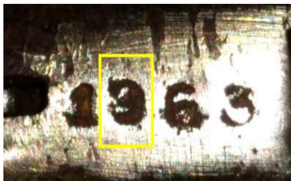
Figura 4 – Imagem do número de série de um revólver antes do ataque químico-metalográfico (à esquerda) e após o ataque químico-metalográfico (à direita).
