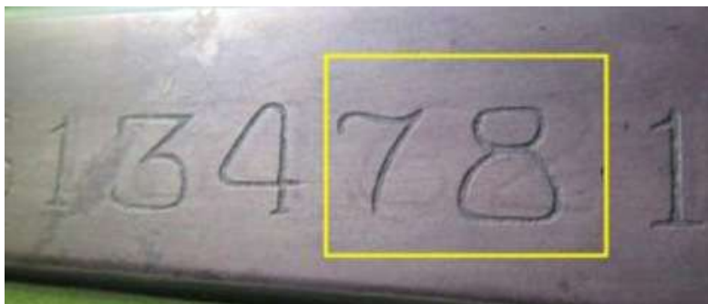
Figura 6 – Imagem da numeração de após o ataque químico-metalográfico.
